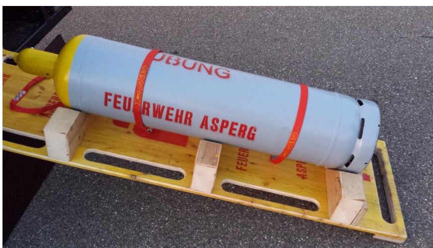
Übungs-Chlor-Flasche auf dem Transportbrett des Druckgas-Bergebehälters
